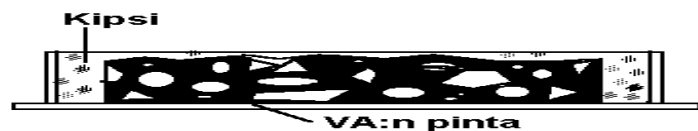
Kuva 2 Päällysteestä poratun näytteen valaminen muottiin
